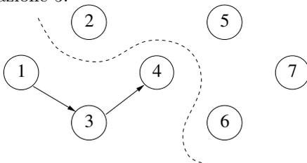
Non esistendo cammini aumentanti, l'ultimo flusso individuato, di valore  $v = 5$ , è massimo, e  $N_s = \{1, 3, 4\}$ ,  $N_t = \{2, 5, 6, 7\}$  è un taglio di capacità minima che separa il nodo 1 dal nodo 7:  $u(N_s, N_t) = u_{12} + u_{46} = 2 + 3 = 5$ .
