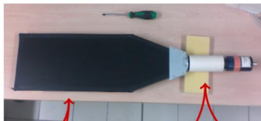
Un tubo fotomoltiplicatore trasforma la luce raccolta in un impulso elettrico
