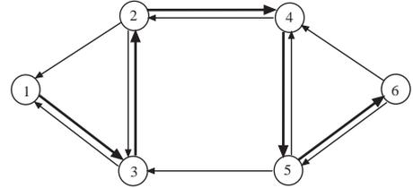
Figura 3.15: il grafo residuo per l’istanza in Figura 3.14
