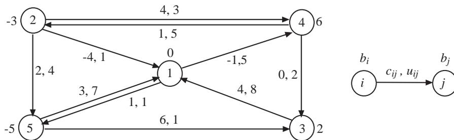
Figura 3.1: Un grafo con domande, offerte, costi e capacità
