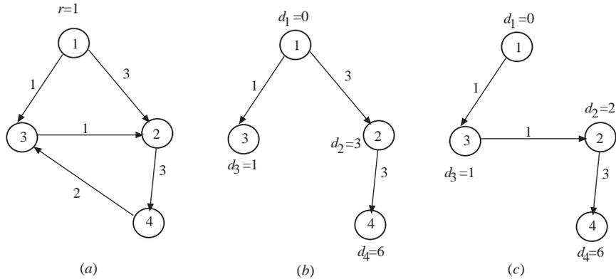
Figura 3.8: Un passo della procedura *SPT*
