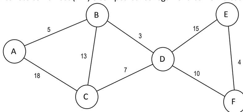
All'istante t=0 ogni router conosce solo il costo per comunicare con i propri vicini ed inizia ad eseguire l'algoritmo Bellman-Ford per la determinazione della propria tabella di routing. Inoltre, le comunicazioni tra
