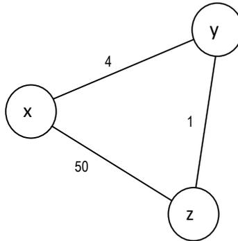
Al tempo T, il costo del collegamento tra x e y passa improvvisamente da 4 a 60. Si chiede di eseguire le prime 10 iterazioni dell'algoritmo distance vector eseguite dai router x, y e z assumendo che i router siano sincronizzati e scambino i vettori di distanza contemporaneamente ogni secondo.
