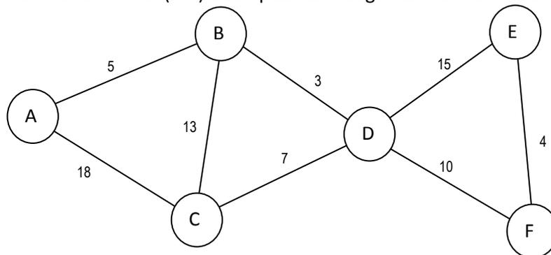
Si utilizzi la seguente tabella per applicare l’algoritmo di Dijkstra per calcolare il contenuto della tabella di routing del router A. Nella tabella N’ è l’insieme dei router raggiunti, D(x) indica il costo per raggiungere x da A, e p(x) indica il predecessore del router x nell’albero dei cammini minimi.
