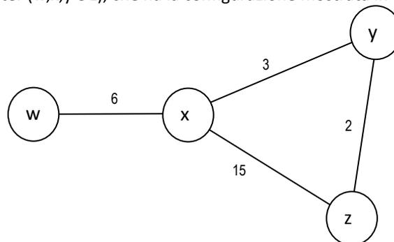
Al tempo t, quando i vettori di distanza dei 4 router sono quelli mostrati in tabella, il costo del collegamento da x a y passa improvvisamente da 3 a 16.
